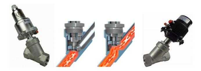
La serie GRS a flusso avviato, con servocomando in acciaio inox AlSI304 o TECNOPOLIMERO. Utilizza materiali più comunemente adottati per i corpi a flusso avviato, ghisa grigia e ghisa sferoidale (GJL250 e GJS500), acciaio al carbonio (WCB/EN 1.0619) e acciaio inox (CF8M/EN1.4408), gli attacchi sono flangiati UNI EN PN 16 o PN 40.
