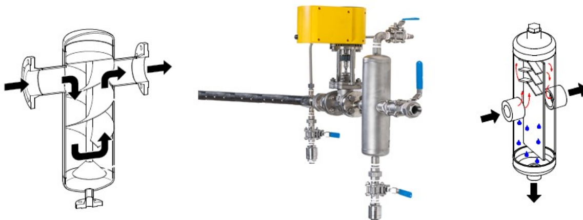
Separatore a doppia elica, a diaframma e applicazione tipo su unità di umidificazione
